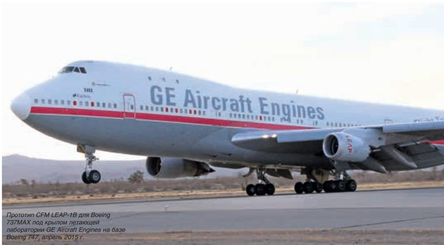
Прототип CFM LEAP-1B для Boeing 737MAX под крылом летающей лаборатории GE Aircraft Engines на базе Boeing 747, апрель 2015 г.
