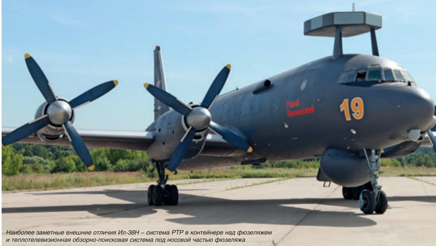
Наиболее заметные внешние отличия Ил-38Н – система РТР в контейнере над фюзеляжем и теплотелевизионная обзорно-поисковая система под носовой частью фюзеляжа
