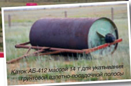
Каток АБ-412 массой 14 т для укатывания грунтовой взлетно-посадочной полосы
