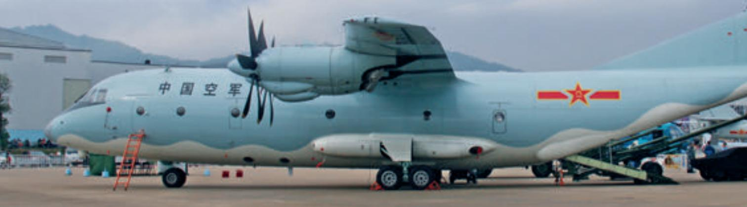
Под носовой частью фюзеляжа Y-9 появился «шарик» опико-электронной системы, а воздушные винты двигателей стали шестилопастными
