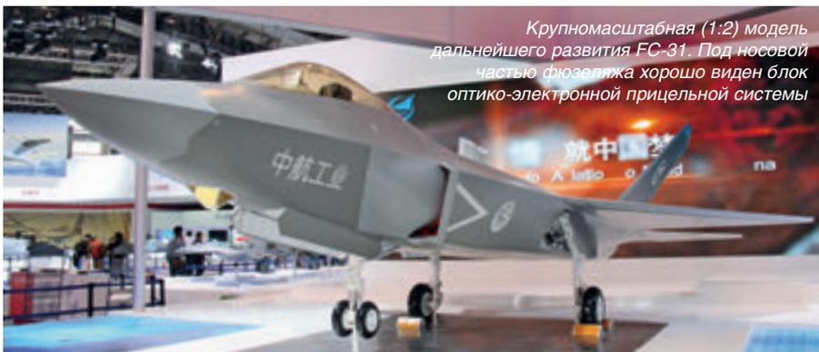
Крупномасштабная (1:2) модель дальнейшего развития FC-31. Под носовой частью фюзеляжа хорошо виден блок оптико-электронной прицельной системы
