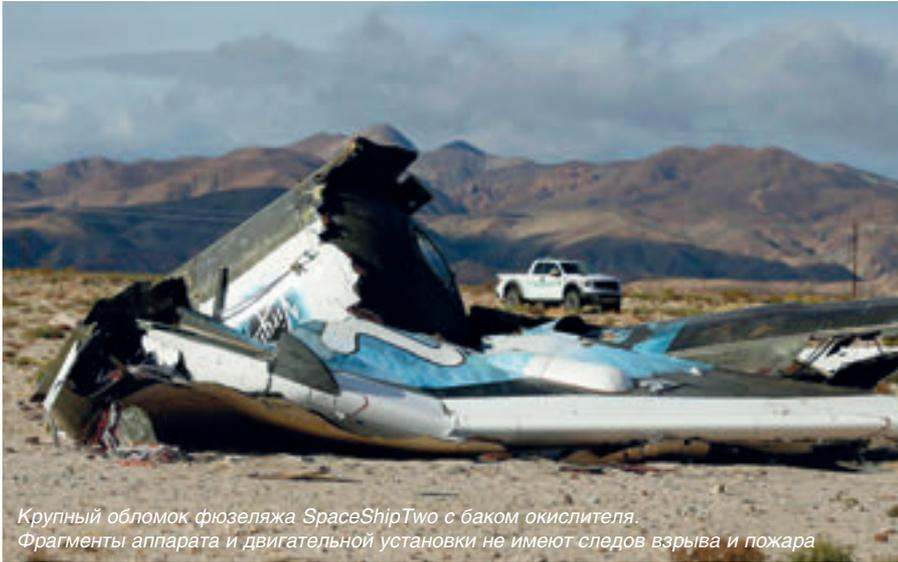
Крупный обломок фюзеляжа SpaceShipTwo с баком окислителя. Фрагменты аппарата и двигательной установки не имеют следов взрыва и пожара
