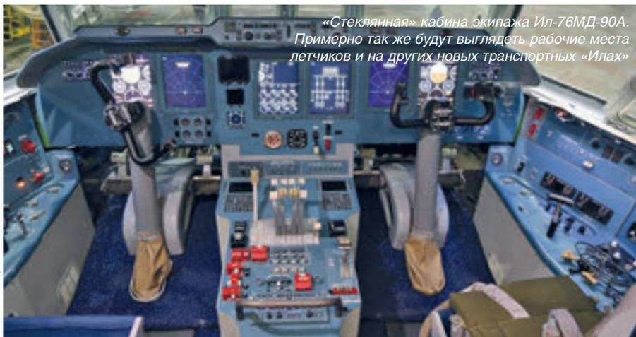
«Стеклопанельная» кабина экипажа Ил-76МД-90А. Примерно так же будут выглядеть рабочие места летчиков и на других новых транспортных «Илах»
