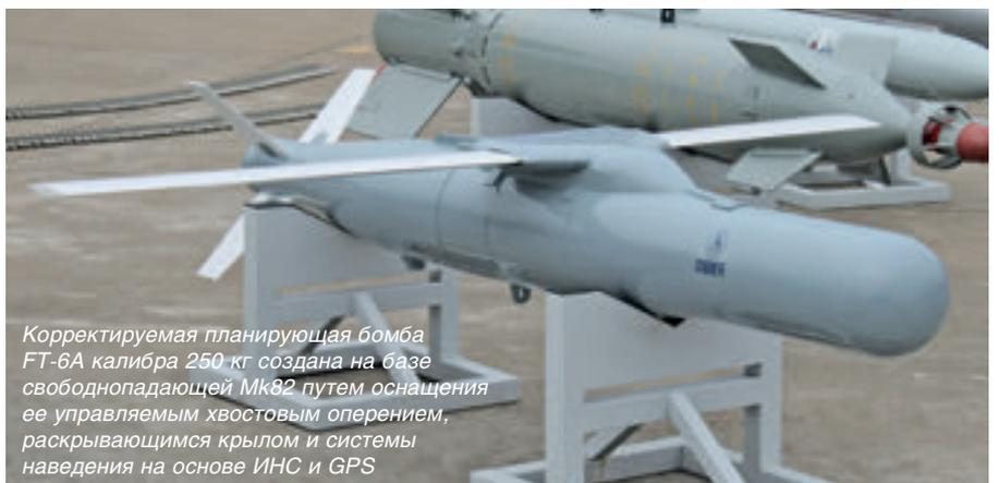
Корректируемая планирующая бомба FT-6A калибра 250 кг создана на базе свободнопадающей Mk82 путем оснащения ее управляемым хвостовым оперением, раскрывающимся крылом и системы наведения на основе ИНС и GPS
