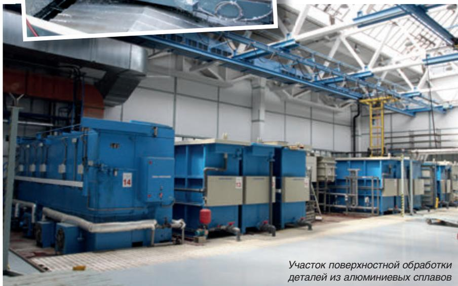
Участок поверхностной обработки деталей из алюминиевых сплавов
