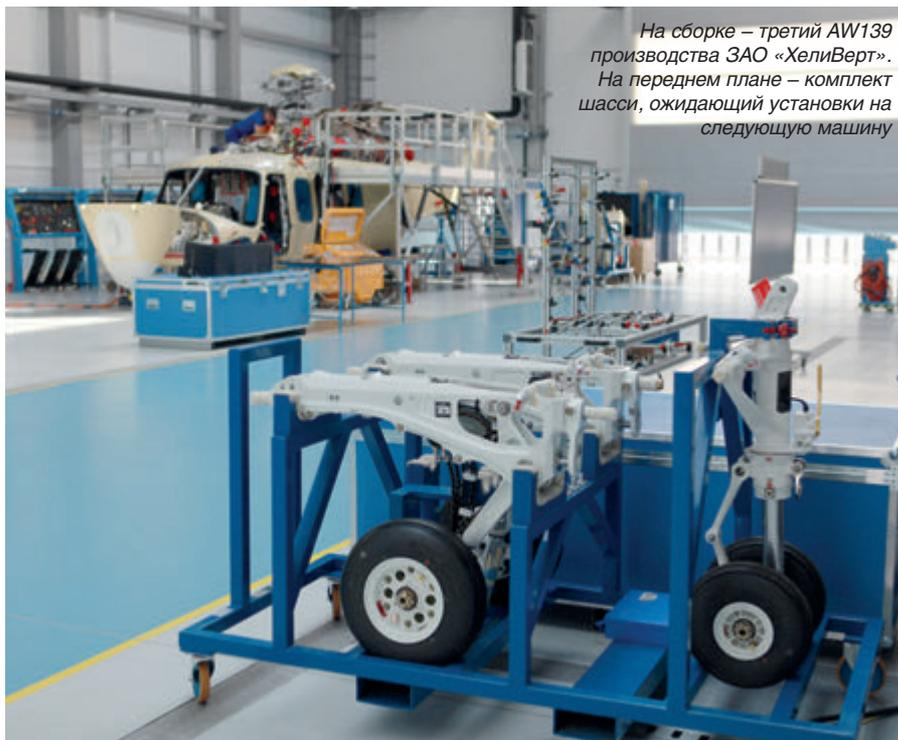
На сборке – третий AW139 производства ЗАО «ХелиВерт». На переднем плане – комплект шасси, ожидающий установки на следующую машину
