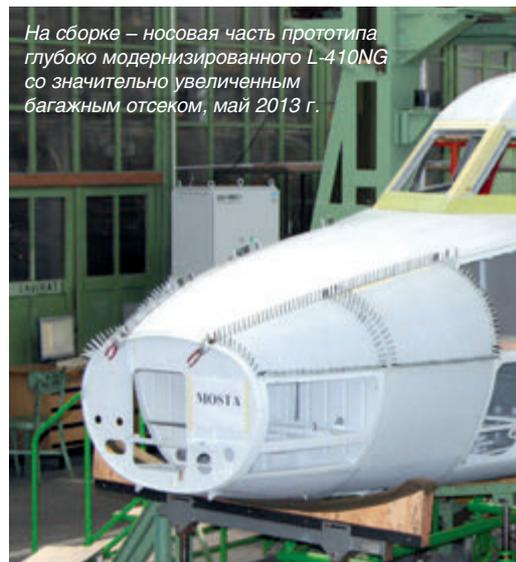
На сборке – носовая часть прототипа глубоко модернизированного L-410NG со значительно увеличенным багажным отсеком, май 2013 г.
