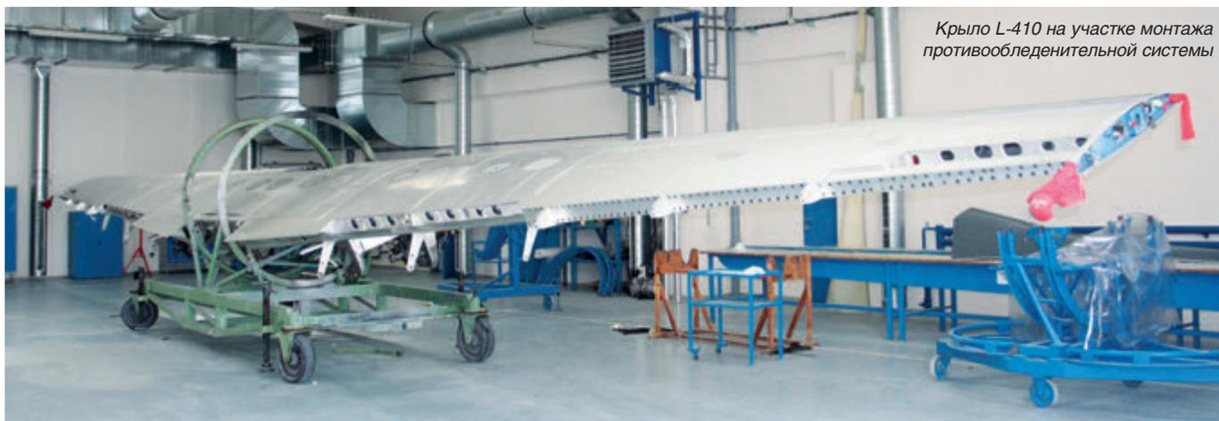
Крыло L-410 на участке монтажа противообледенительной системы
