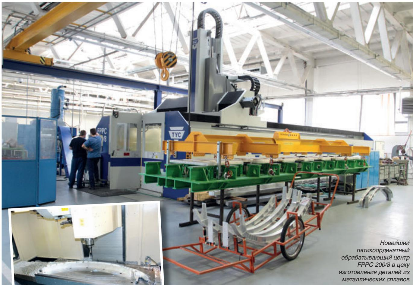
Новейший пятикоординатный обрабатывающий центр FPPC 200/8 в цеху изготовления деталей из металлических сплавов
