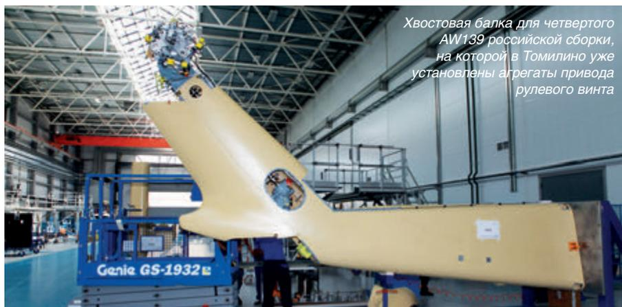
Хвостовая балка для четвертого AW139 российской сборки, на которой в Томилино уже установлены агрегаты привода рулевого винта
