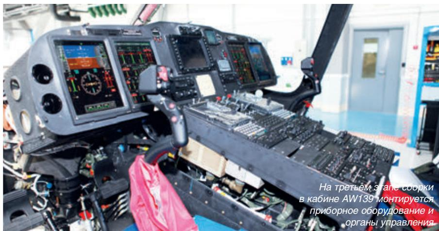
На третьем этапе сборки в кабине AW139 монтируется приборное оборудование и органы управления
