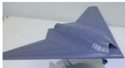
ловидности по передней кромке с концевыми неподвижными аэродинамическими поверхностями — управление по курсу по-прежнему осуществляется дифференциальным отклонением элеронов. Модель также снабжена тормозным гаком. Она демонстрировалась, в частности, в ходе Air Show China 2012 в Чжухае.
