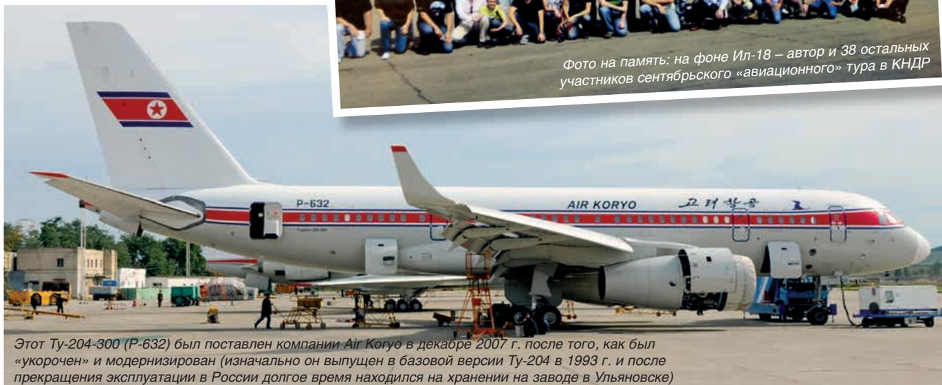
Этот Ту-204-300 (Р-632) был поставлен компании Air Koryo в декабре 2007 г. после того, как был «укорочен» и модернизирован (изначально он выпущен в базовой версии Ту-204 в 1993 г. и после прекращения эксплуатации в России долгое время находился на хранении на заводе в Ульяновске)
