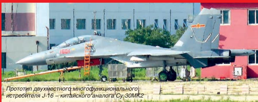
Прототип двухместного многофункционального истребителя J-16 — китайского аналога Су-30МК2
