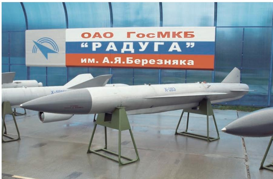
Первая тактическая противорадиолокационная ракета «Радуги» с ЖРД Х-28 (вверху) и ее преемница с твердотопливным двигателем Х-58 (справа)
