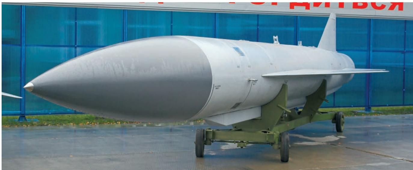
**Вверху:** ракета «воздух–поверхность» X-22, до сих пор состоящая на вооружении ракетно-бомбардировщиков Ту-22М3
