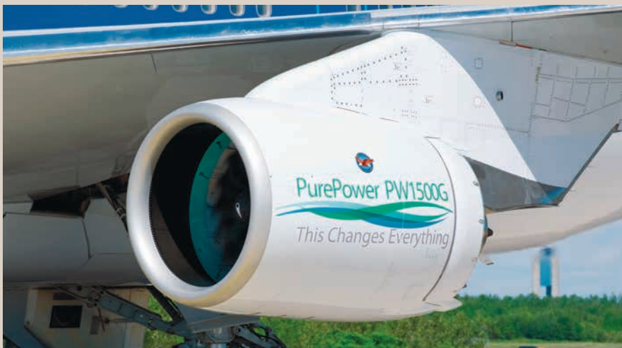
Испытания прототипа двигателя PW1500G для самолетов CS100/300 компании «Бомбардье» на летающей лаборатории «Боинг» 747SP. На заставке слева – испытания PW1524G на открытом стенде компании «Пратт-Уитни» в Вест-Палм-Бич во Флориде
