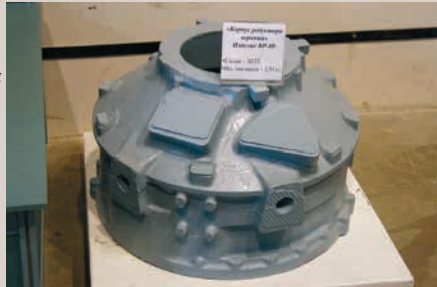
Новый литейный комплекс итальянской фирмы IMF и образцы изготовленных на нем деталей трансмиссии вертолетов Ка-50 и Ка-52: верхний и нижний корпуса главного редуктора ВР-80 (слева и в середине), корпус промежуточного редуктора ПВР-800 (справа)
