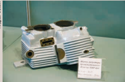
Новый литейный комплекс итальянской фирмы IMF и образцы изготовленных на нем деталей трансмиссии вертолетов Ка-50 и Ка-52: верхний и нижний корпуса главного редуктора ВР-80 (слева и в середине), корпус промежуточного редуктора ПВР-800 (справа)
