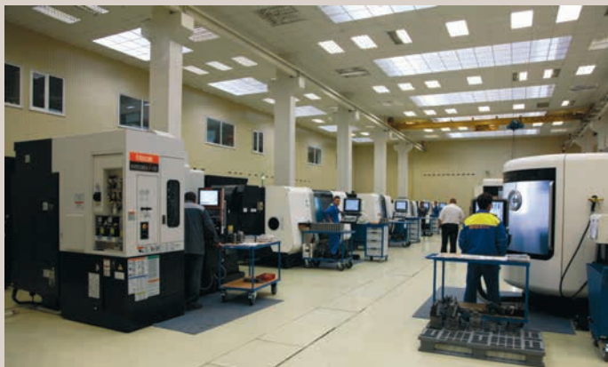
Недавно приобретенные «Прогрессом» новейшие пятикоординатные обрабатывающие центры фирм DMG и MAZAK в цехе высокоточной механической обработки
