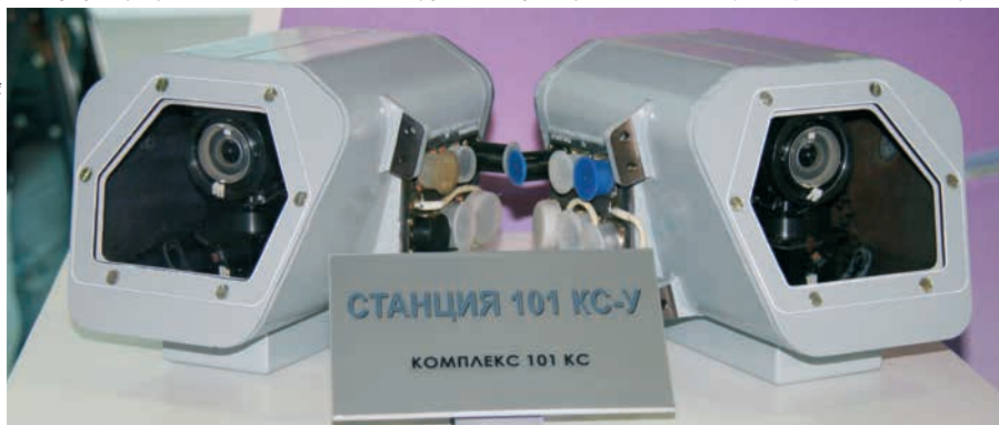
Вверху: оптико-локационная станция 101К5-В (слева) и подвесная оптико-электронная система 101К5-Н для работы по наземным целям (справа) Внизу: ультрафиолетовые датчики обнаружения пуска ракет 101К5-У (слева) и оптико-электронная подсистема обороны 101К5-О (справа)
