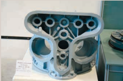
Новый литейный комплекс итальянской фирмы IMF и образцы изготовленных на нем деталей трансмиссии вертолетов Ка-50 и Ка-52: верхний и нижний корпуса главного редуктора ВР-80 (слева и в середине), корпус промежуточного редуктора ПВР-800 (справа)
