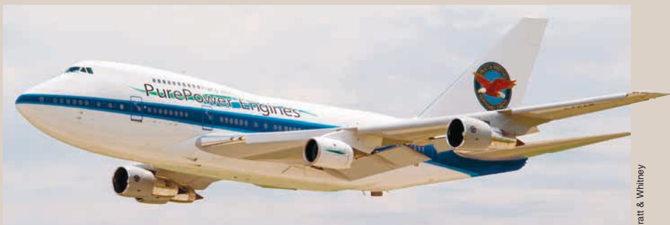
Испытания прототипа двигателя PW1500G для самолетов CS100/300 компании «Бомбардье» на летающей лаборатории «Боинг» 747SP. На заставке слева – испытания PW1524G на открытом стенде компании «Пратт-Уитни» в Вест-Палм-Бич во Флориде
