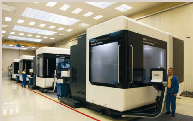
Недавно приобретенные «Прогрессом» новейшие пятикоординатные обрабатывающие центры фирм DMG и MAZAK в цехе высокоточной механической обработки
