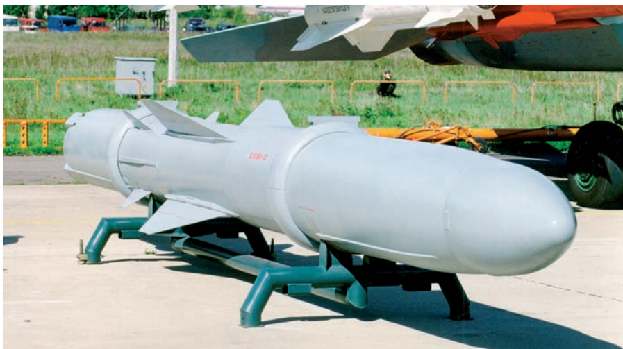
Макет авиационного варианта ПКР «Яхонт». До пуска с самолета-носителя воздухозаборник и сопло ракеты закрыты обтекателями
