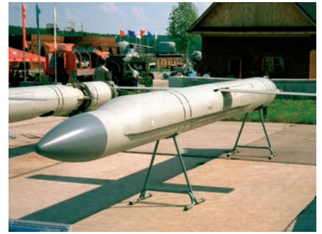
Сверхзвуковая трехступенчатая ПКР 3М54Э системы «Клуб»
