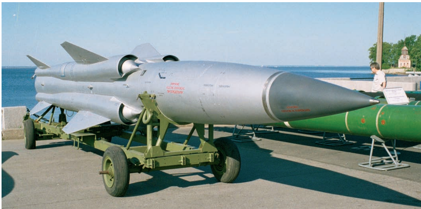
ПКР «Москит» на тележке (вверху) и ее макет на подвеске самолета Су-33 (внизу)
