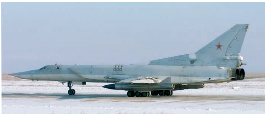
Авиационная ПКР Х-22М на транспортировочной тележке (внизу) и под крылом самолета-носителя Ту-22М3 (вверху)
