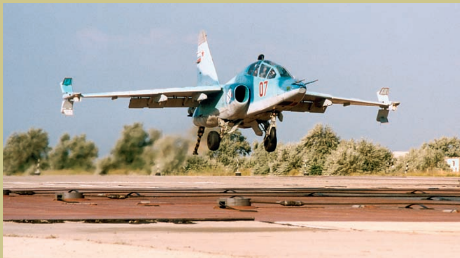
Внизу: Су-25УТГ за мгновение до зацепа за трос аэрофинишера «Нитки»
