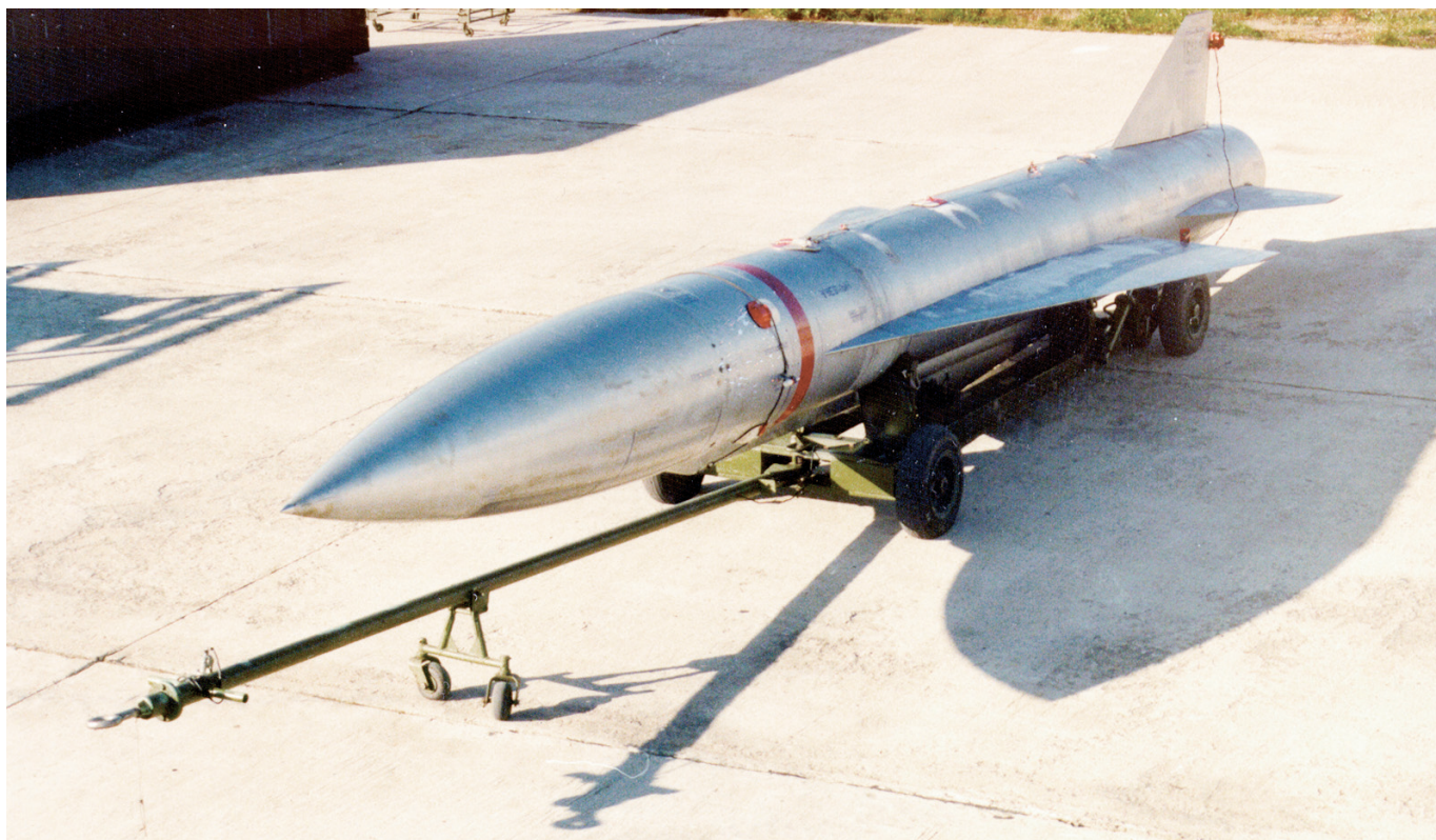
Авиационная ПКР Х-22М на транспортировочной тележке (внизу) и под крылом самолета-носителя Ту-22М3 (вверху)
